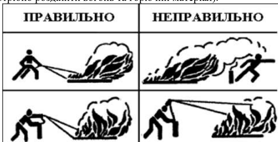
Використання вогнегасника: - з навітряної сторони; - у рівнинних умовах зі сторони фронту пожежі
