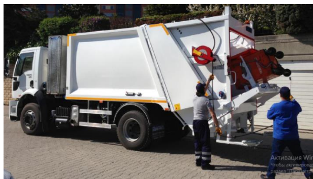
Фото. Сміттевоз HIDRO MAK з функцією миття та дезінфекції контейнерів
